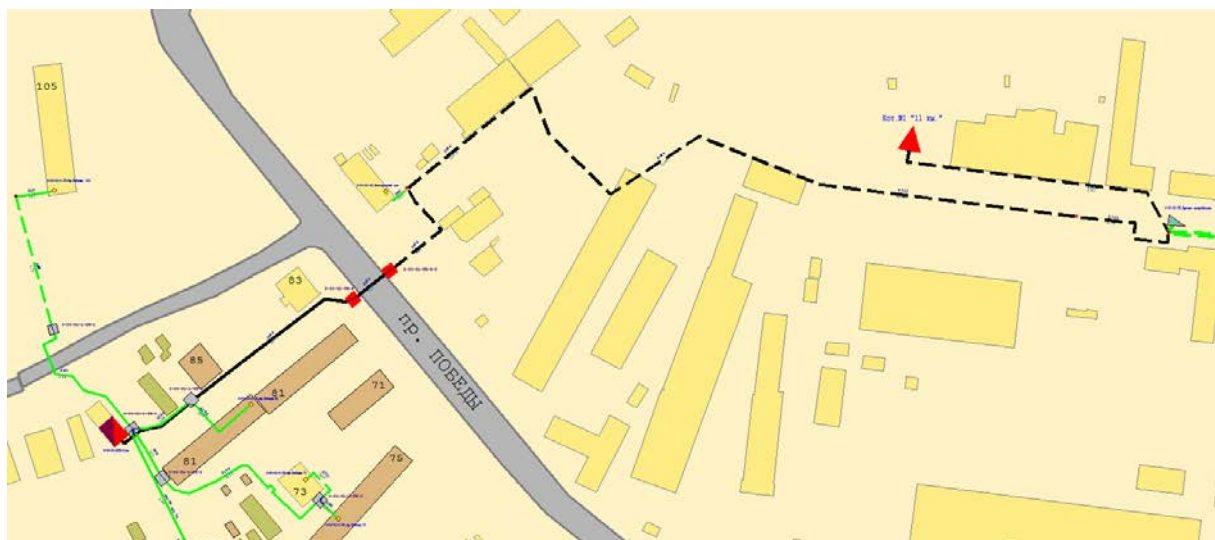
Рисунок 2.83 – Расчетный путь теплоносителя №1 от котельной №1 «11 км»
