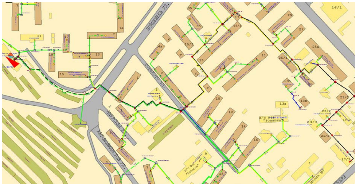
Рисунок 2.3. – Расчетный путь теплоносителя №2 от котельной №50 «101 квартал»
