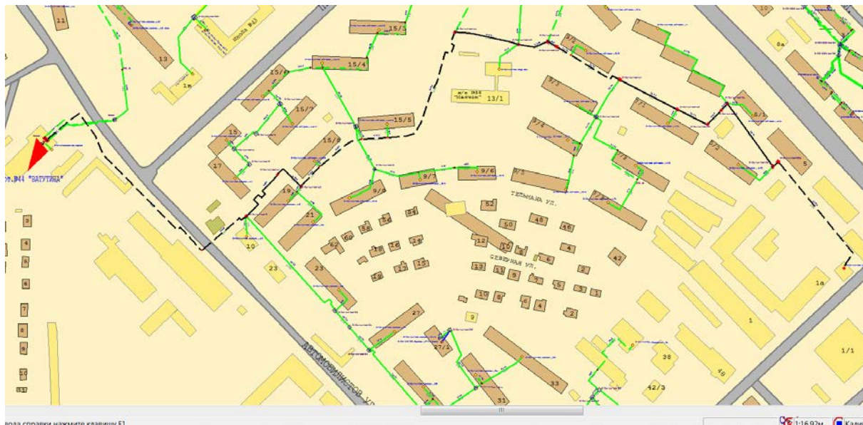
Рисунок 2.23. – Расчетный путь теплоносителя №2 от котельной №44 «Ватутина»
