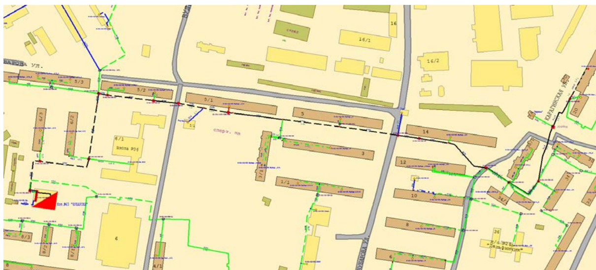
Рисунок 2.13. – Расчетный путь теплоносителя №1 от котельной №43 «Чубарова»
