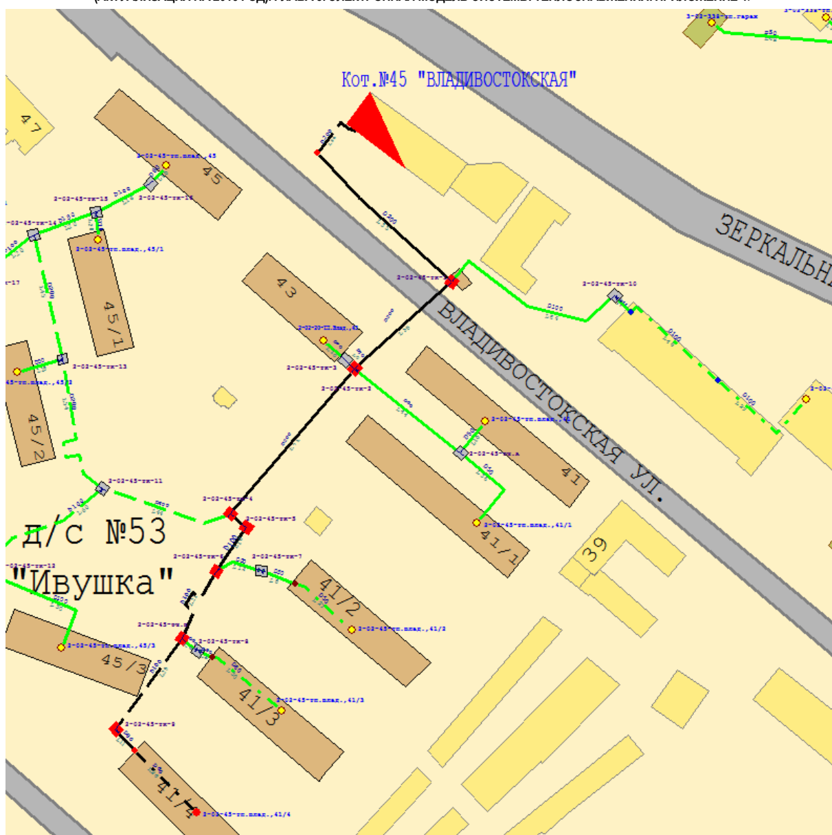
Рисунок 2.45 – Расчетный путь теплоносителя №1 от котельной №45 «Владивостокская»
