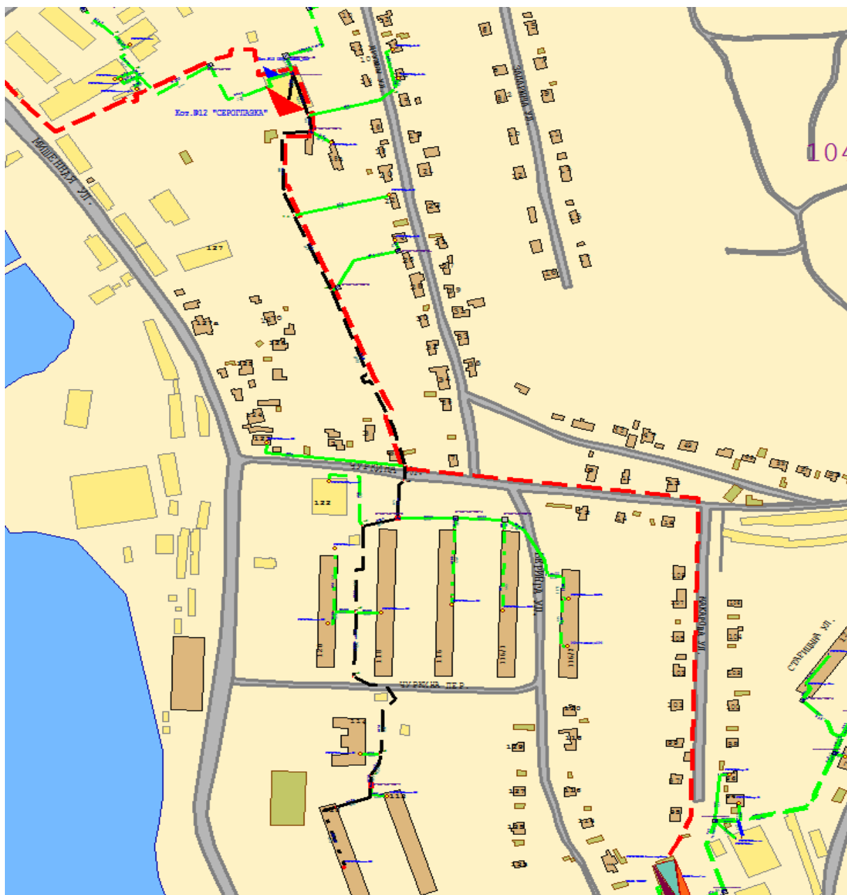
Рисунок 2.35. – Расчетный путь теплоносителя №2 от котельной №12 - «Сероглазка»
