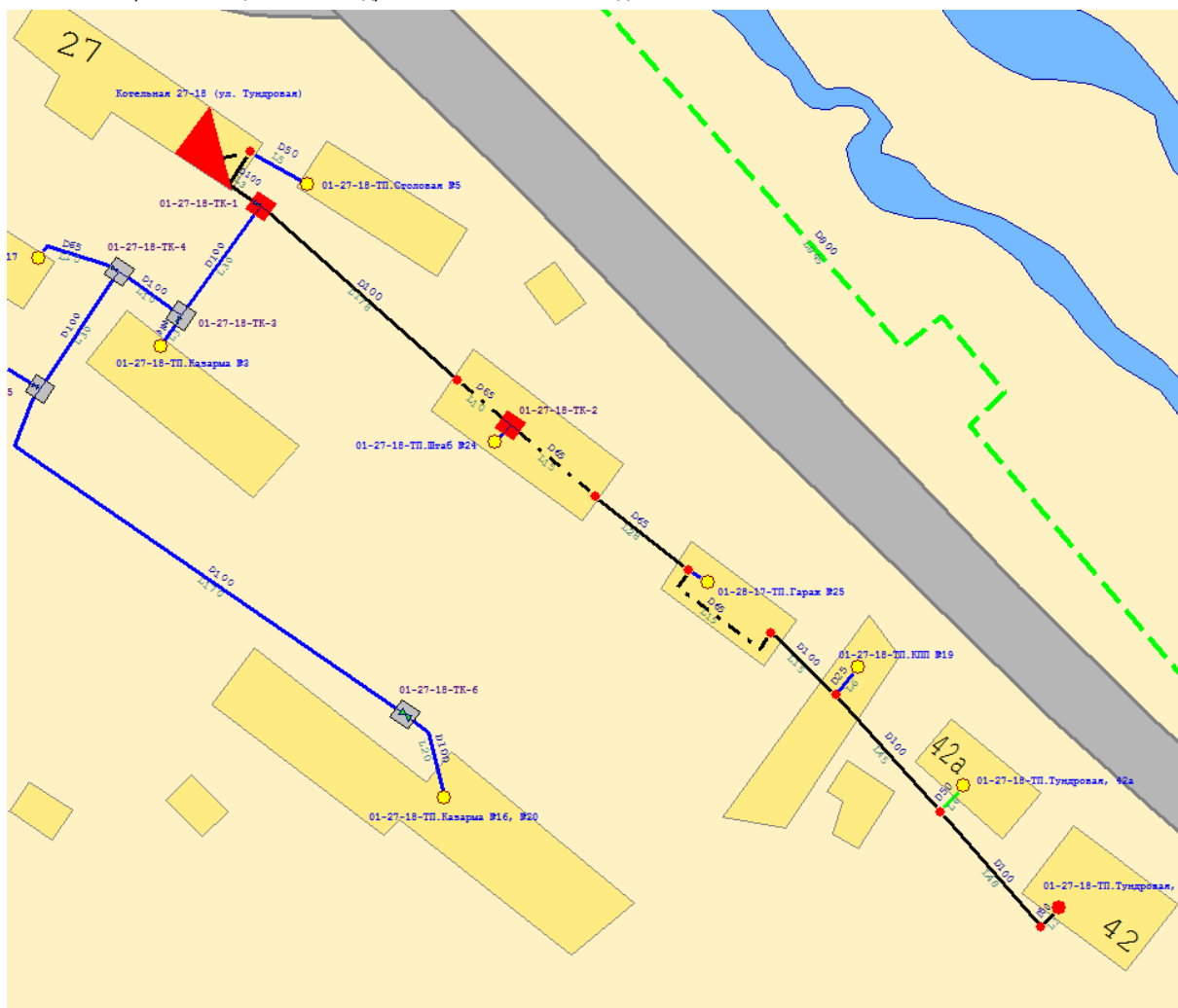
Рисунок 3.3. – Расчетный путь теплоносителя №1 от котельной 27-18
