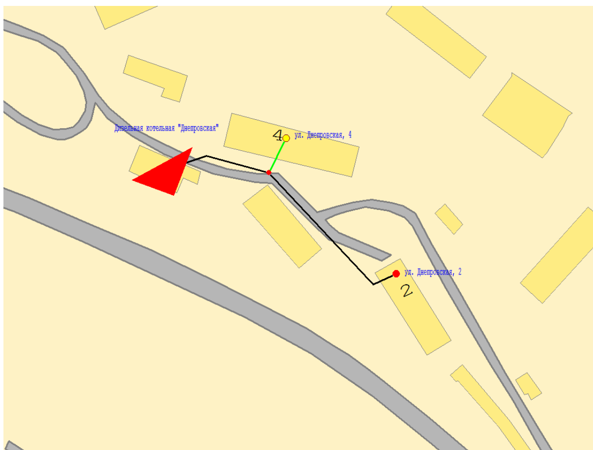
Рисунок 4.1. – Расчетный путь теплоносителя дизельной котельной до конечного потребителя Днепровская, 2
