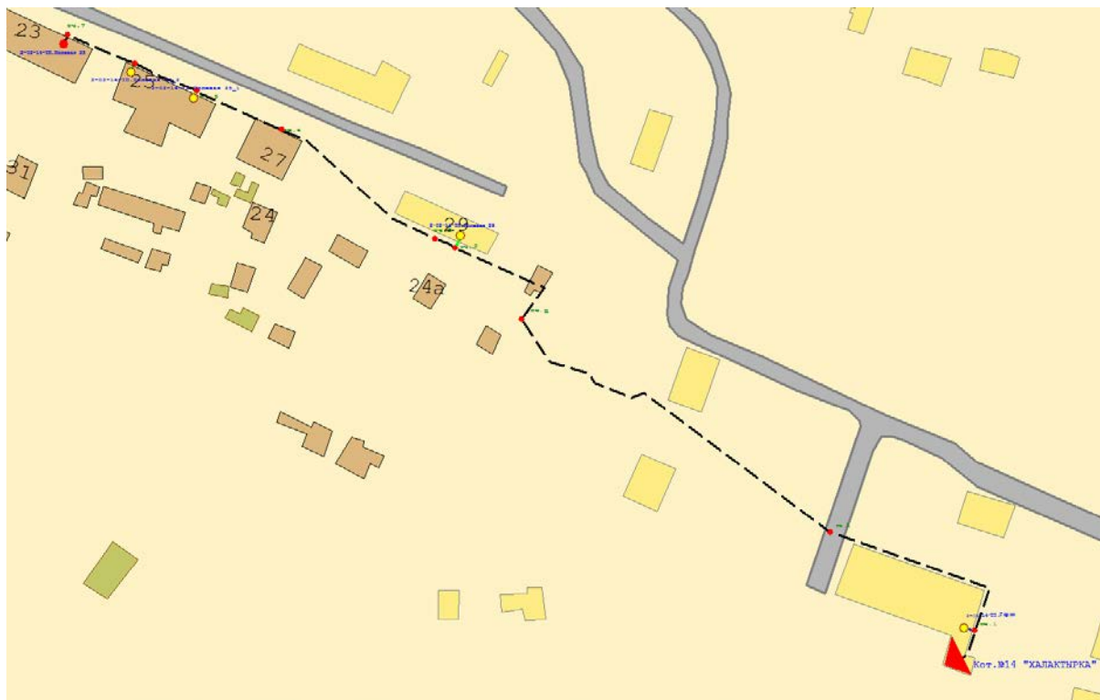
Рисунок 2.71. – Расчетный путь теплоносителя котельной №14 «Халактырка» до конечного потребителя ул. Полевая,23
