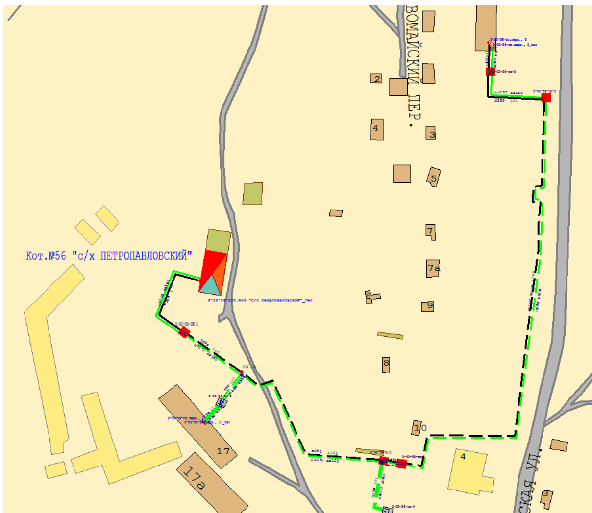
Рисунок 2.65. – Расчетный путь теплоносителя №2 от котельной №56 «с/х Петропавловский»
