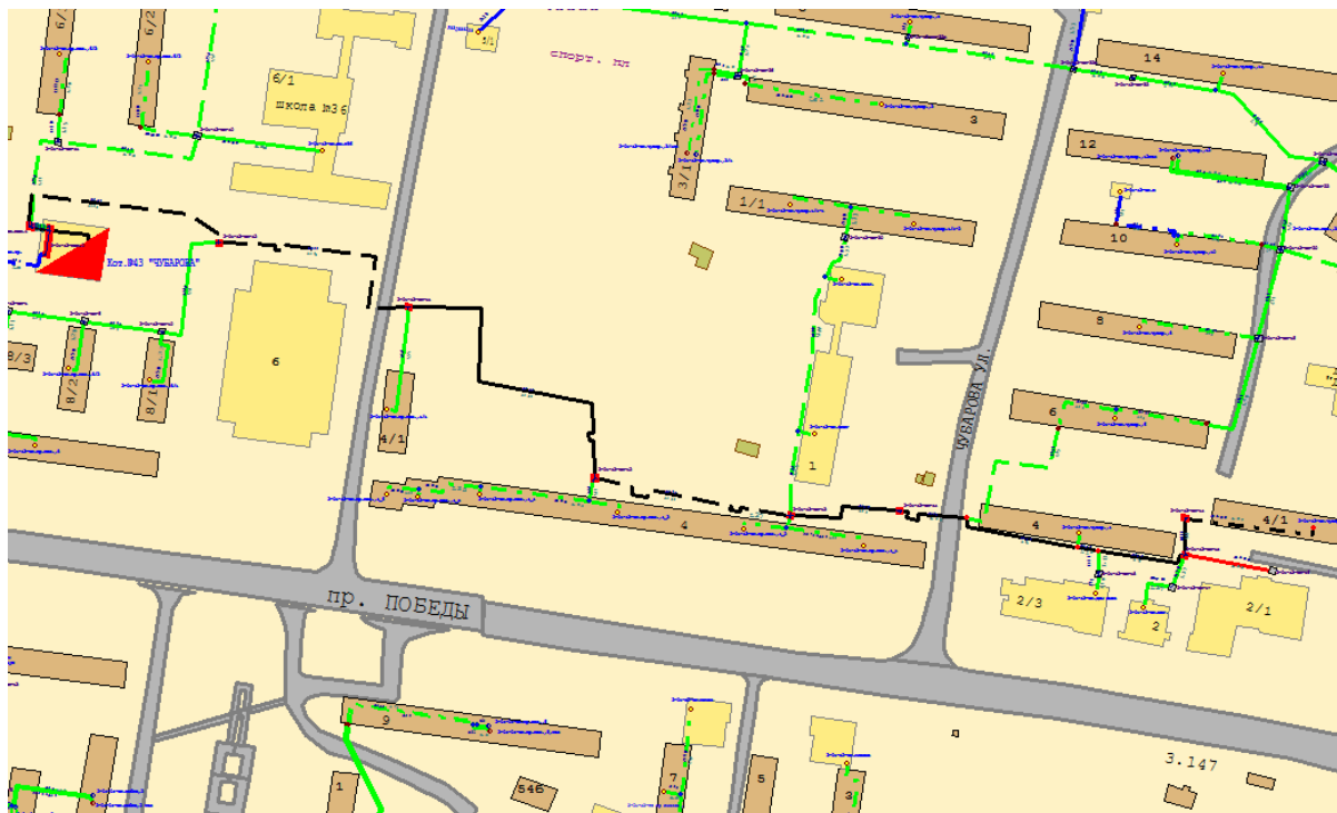
Рисунок 2.15. – Расчетный путь теплоносителя №2 от котельной №43 «Чубарова»
